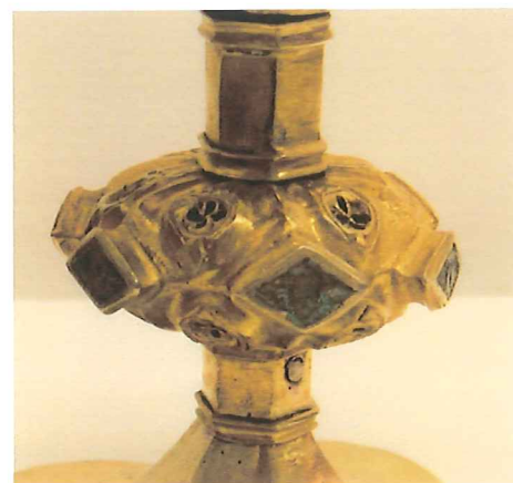
Gröna korrosionsfläckar på nodens knoppar
