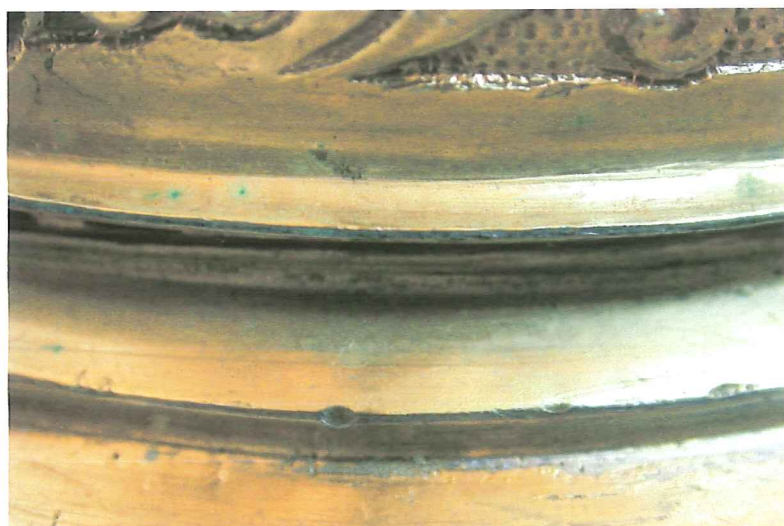
Gröna korrosionsprodukter på kannans fot.
