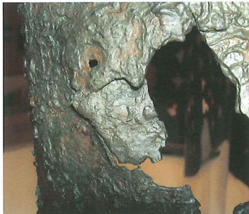
Löst fragment samt rostfläckar, före konservering.
