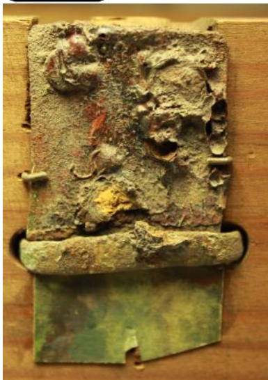
Korrosionsangrepp på järnbeslagen.
