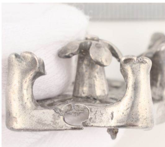
Fig.7 Äldre brott som genom avlägsnandet av gammal fog och den efterföljande sammanfogningen getts en bättre passning
